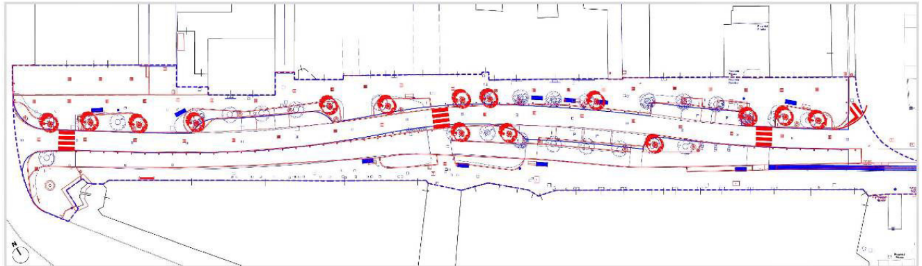
PLANIMETRIA PRIMO STRALCIO REALIZZATO - SOVRAPPOSIZIONE: PROGETTO DEFINITIVO 1° STRALCIO (BLU) RILIEVO 1° STRALCIO REALIZZATO (ROSSO)
